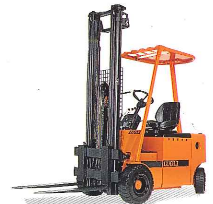
MOD. ET 18 Portata/baricentro Kg/mm 1.800/500 Larghezza V-V/ L/L mm. 980/1.025 Corridoio ast (1000x1200) mm. 3.250
