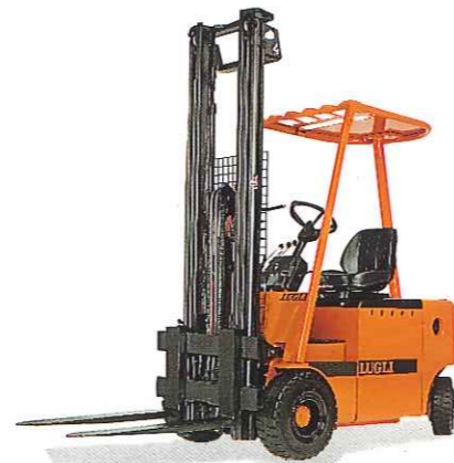
MOD. E 18 Portata/baricentro Kg/mm 1.800/500 Larghezza V-V/ L/L mm. 980/1.025 Corridoio ast (1000x1200) mm. 3.250
