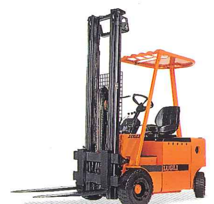
MOD. ETX 23 Portata/baricentro Kg/mm 2.300/500 Larghezza V-V/ L/L mm. 1.025/1.075 Corridoio ast (1000x1200) mm. 3.280
