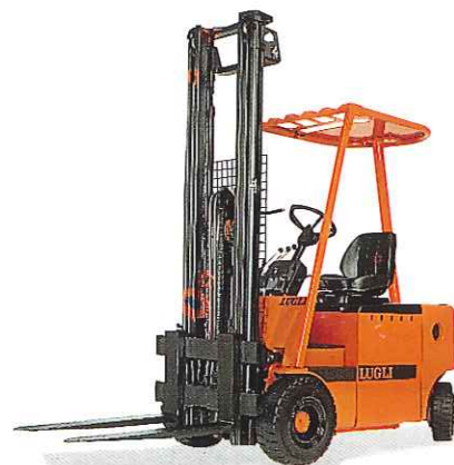
MOD. ET 20 Portata/baricentro Kg/mm 2.000/500 Larghezza V-V/ L/L mm. 1.025/1.075 Corridoio ast (1000x1200) mm. 3.250
