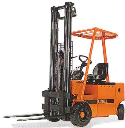
MOD. E 15 Portata/baricentro Kg/mm 1.500/500 Larghezza V-V/ L/L mm. 980/1.025 Corridoio ast (1000x1200) mm. 3.250
