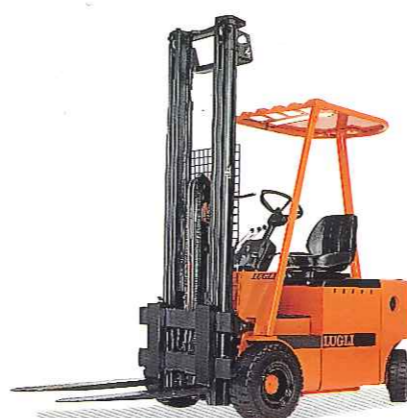
MOD. ETX 18 Portata/baricentro Kg/mm 1.800/500 Larghezza V-V/ L/L mm. 1.025/1.025 Corridoio ast (1000x1200) mm. 3.280
