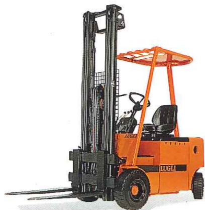
MOD. ET 23 Portata/baricentro Kg/mm 2.300/500 Larghezza V-V/ L/L mm. 1.025/1.075 Corridoio ast (1000x1200) mm. 3.250
