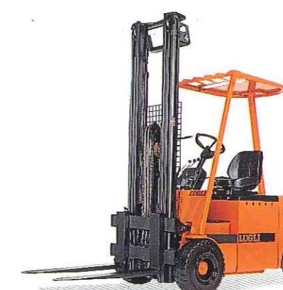
MOD. ETX 20 Portata/baricentro Kg/mm 2.000/500 Larghezza V-V/ L/L mm. 1.025/1.075 Corridoio ast (1000x1200) mm. 3.280
